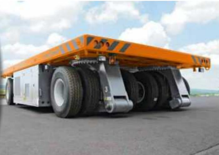
Luftbereifter Mehrwege-Plattformtransporter, Tragfähigkeit bis 80 t
