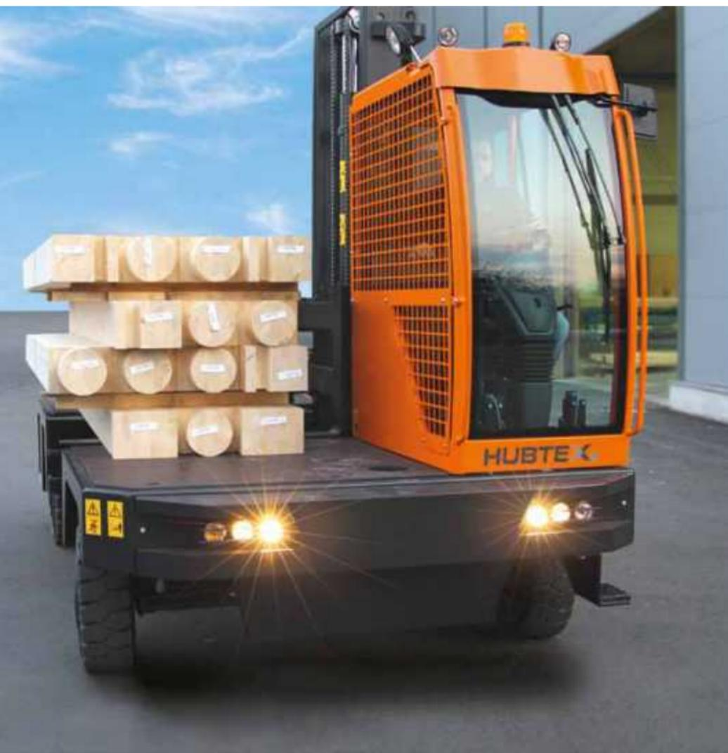
Seitenstapler mit großer Bereifung und hohen Fahrgeschwindigkeiten
