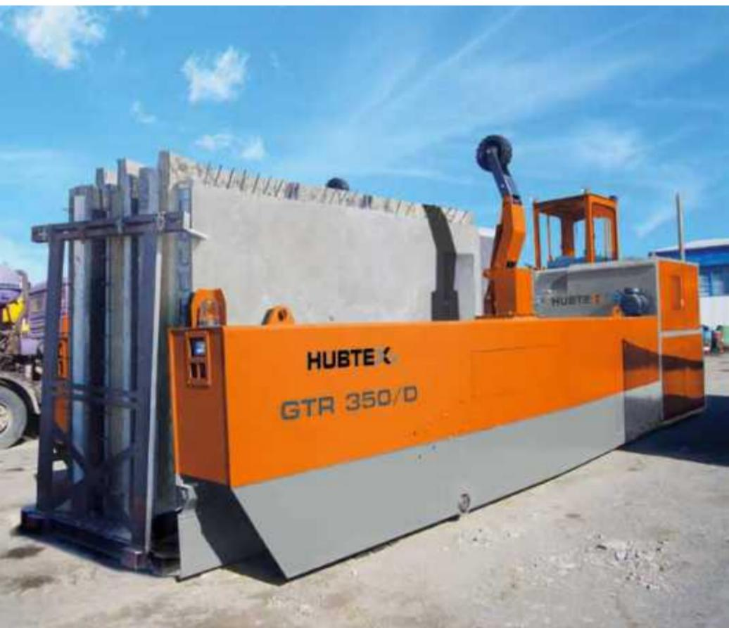
Transport von Gestellen mit Betonfertigelementen, Tragfähigkeit 35 t
