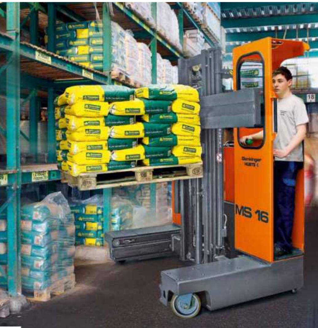
Kompakter Mehrwege-Seitenstapler eingesetzt in Baumärkten
