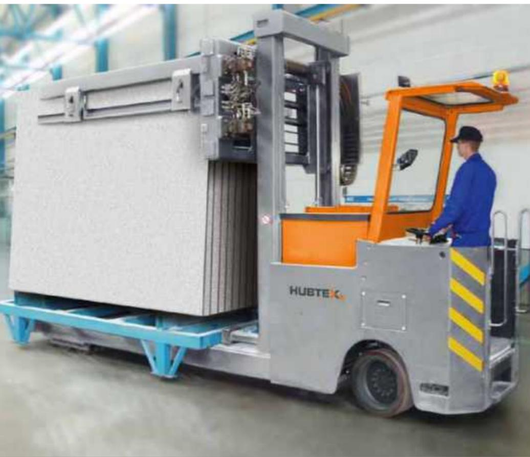
GTT P beim Handling von Gestellen mit Betonplatten
