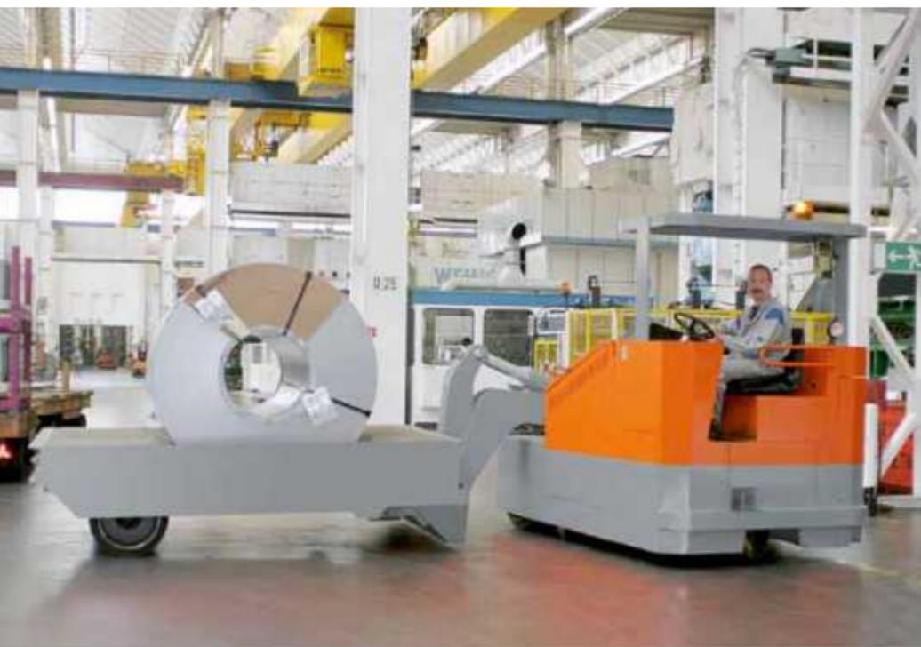
Zugkopf mit Schwanenhals für den Transport von Cargo-Trailern
