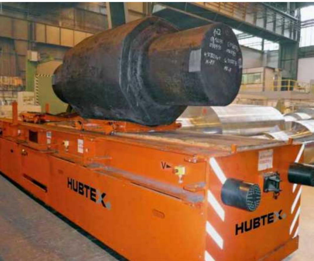
Gleiswagen für den Transport von Schmiedeteilen, Tragfähigkeit von 10–230 t
