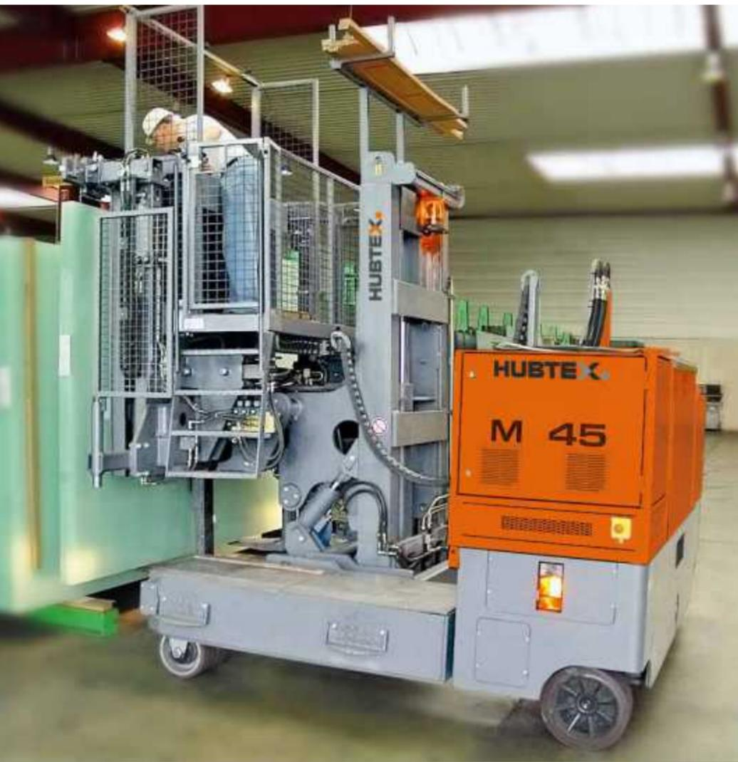
Mehrwege-Seitenstapler für das Handling von unverpackten Glaspaketen
