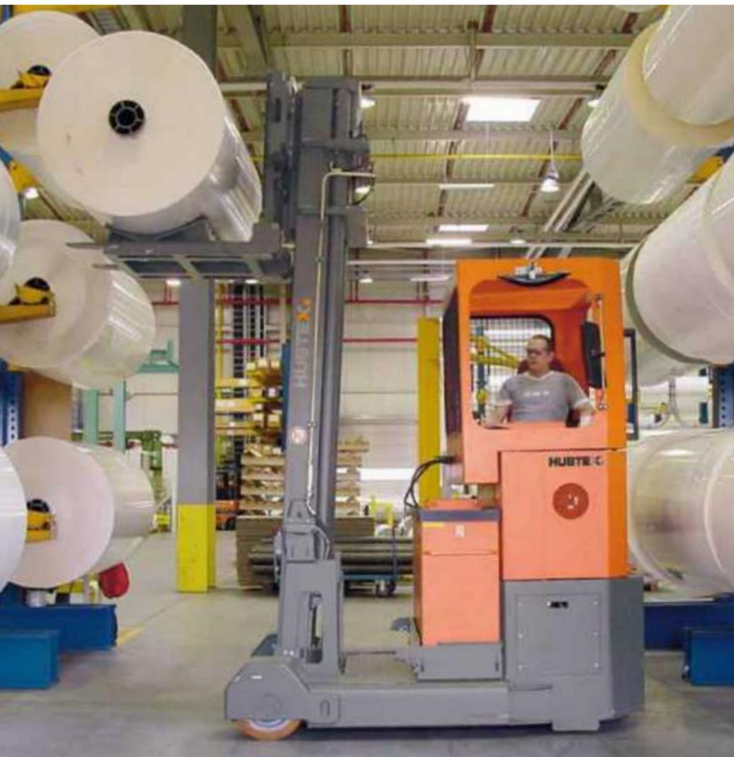
Schubmaststapler für das Handling von Papierrollen, Tragfähigkeiten 3,5–6 t
