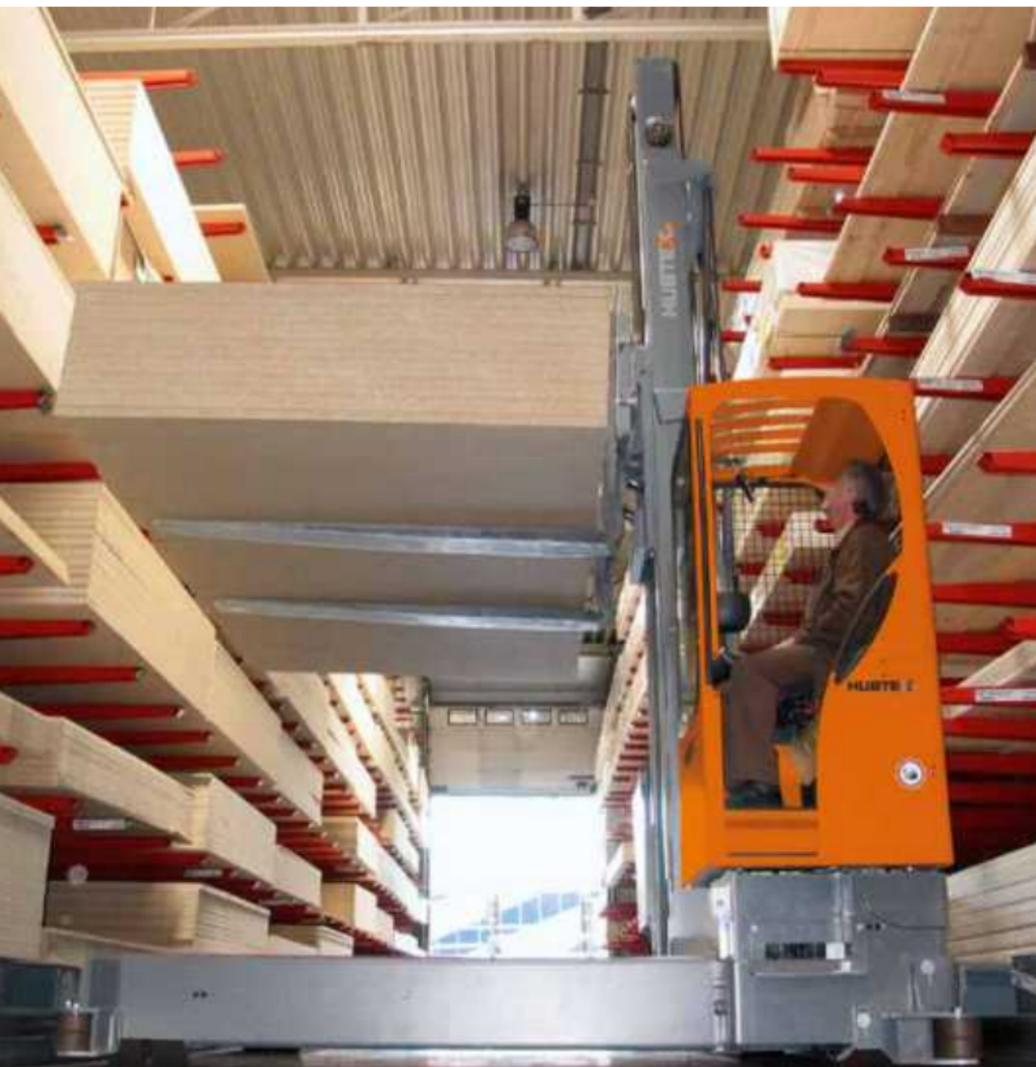
Mehrwege-Seitenstapler beim Handling von Spanplatten
