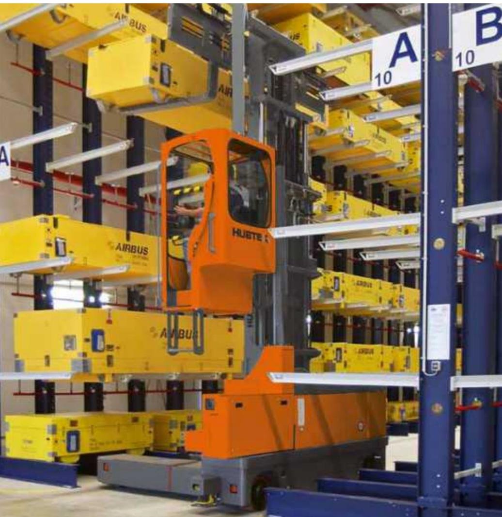
Mehrwege-Seitenstapler im Ersatzteillager bei Flugzeugherstellern
