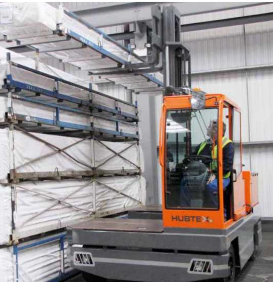
Seitenstapler mit Diesel-, Gas- oder Elektroantrieb
