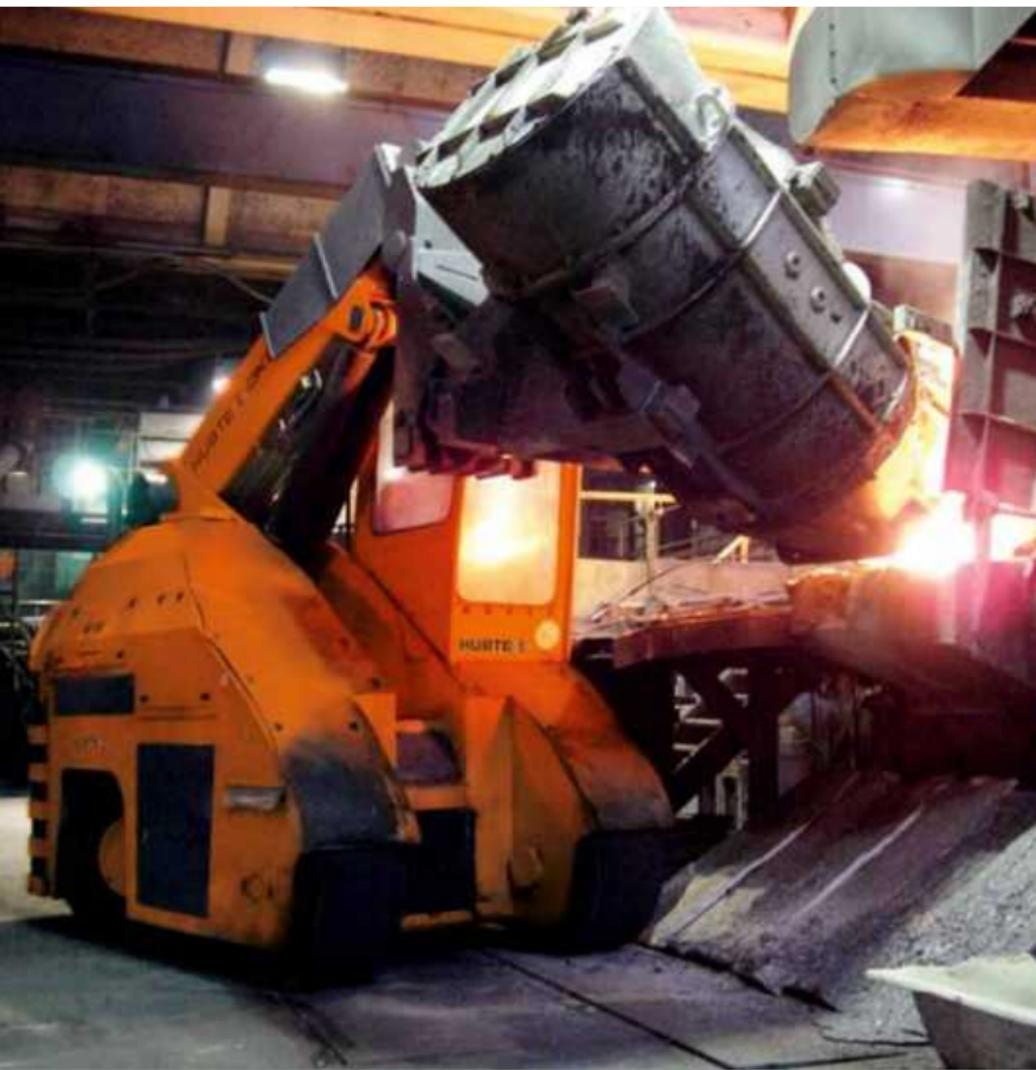
Teleskoparm-Kompaktstapler für das Handling von Konvertern
