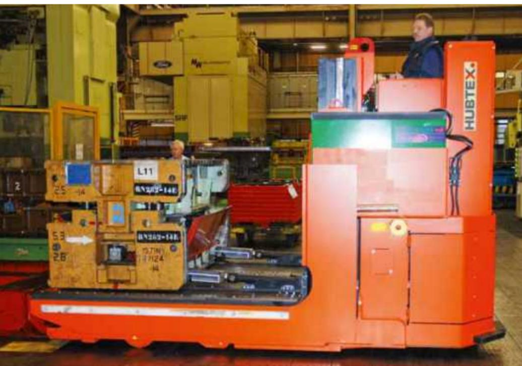
Werkzeugwechsel und -transport innerhalb des Presswerkes
