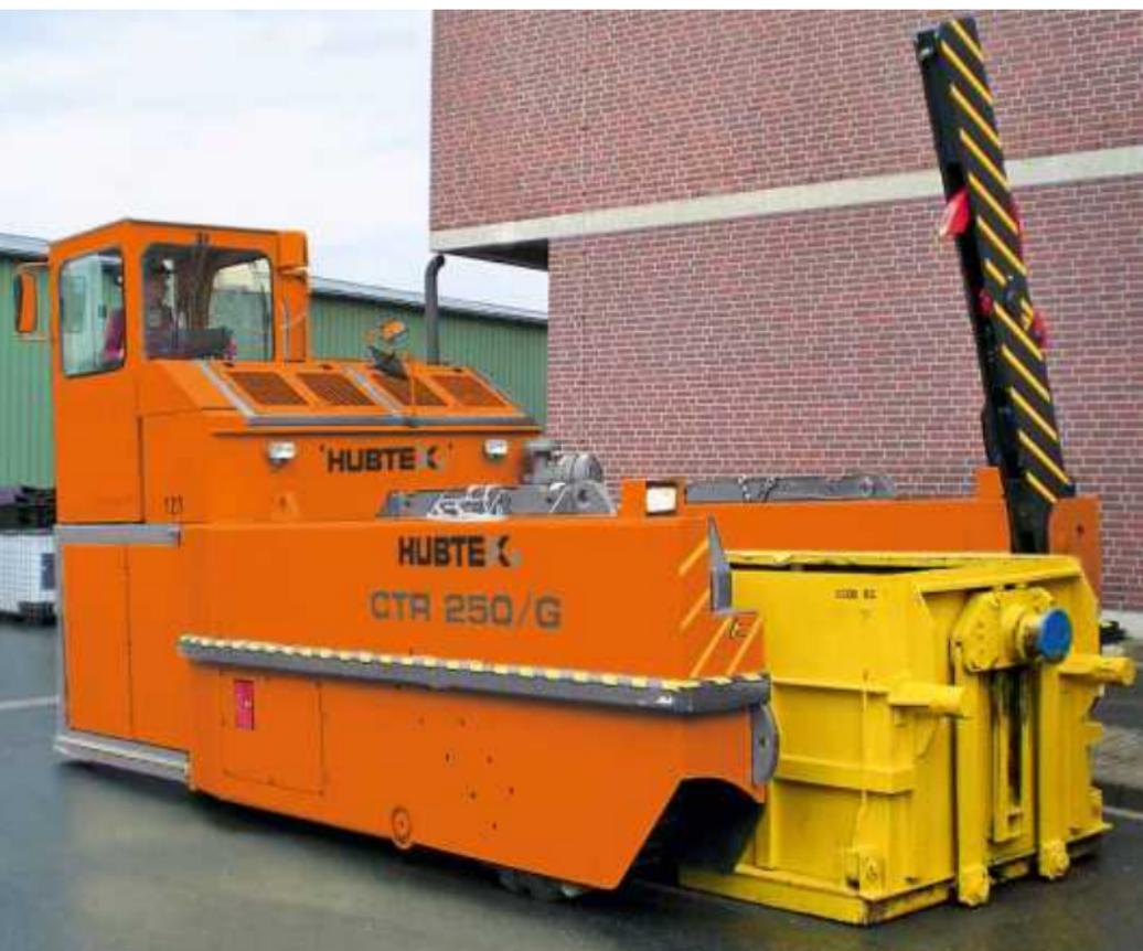
Transporter für Schrott-Container, Tragfähigkeit bis 50 t
