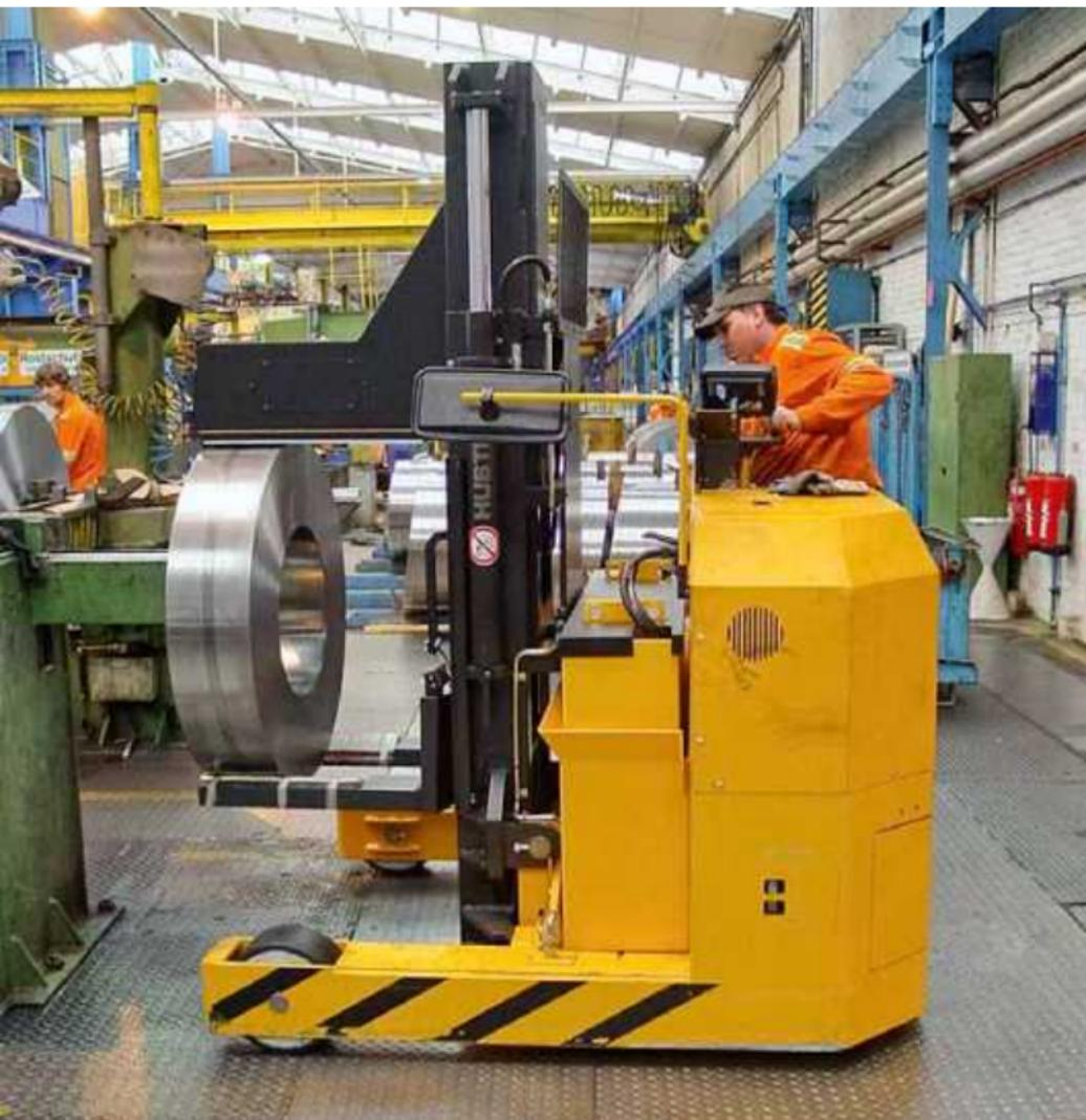
Transporter zur Ver- und Entsorgung von Stahl-Coils an einer Längsteilanlage
