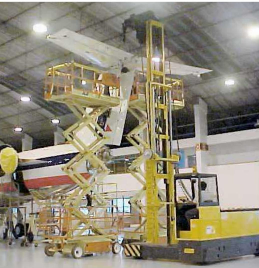
Mehrwege-Seitenstapler zum Einbau von Flugzeugkomponenten
