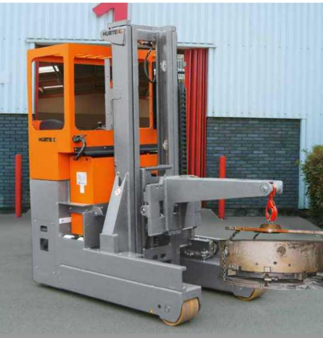
Schubmaststapler für das Handling von Reifenformen
