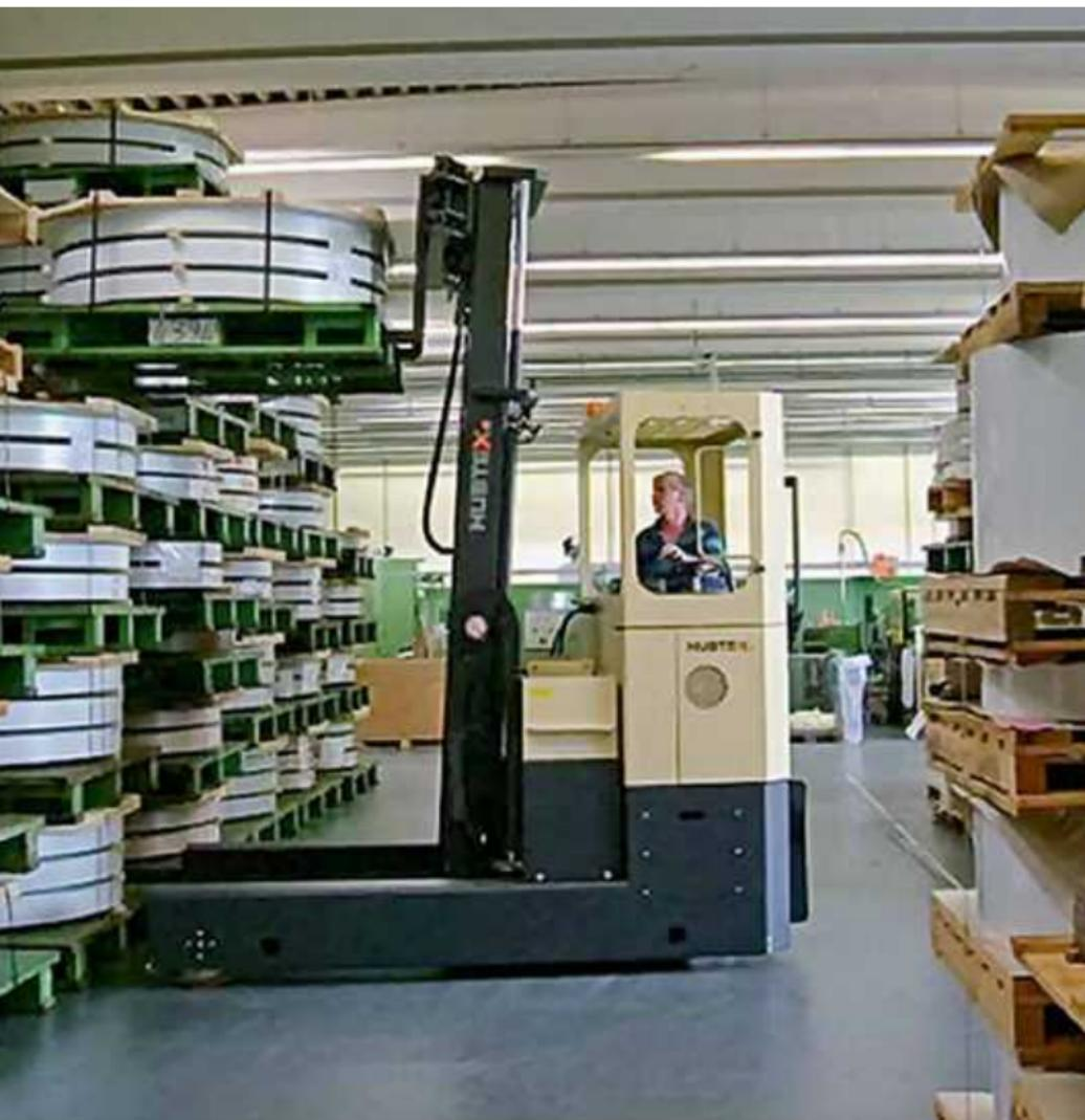
Schubmaststapler mit Tragfähigkeiten 3,5–6 t
